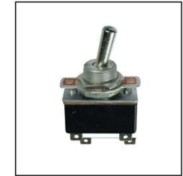
EC-1502 D.P.D.T. CENTER-OFF TOGGLE SWITCH • Mount Size : 12/25" • 117V AC • 4 Amp • 6 P
